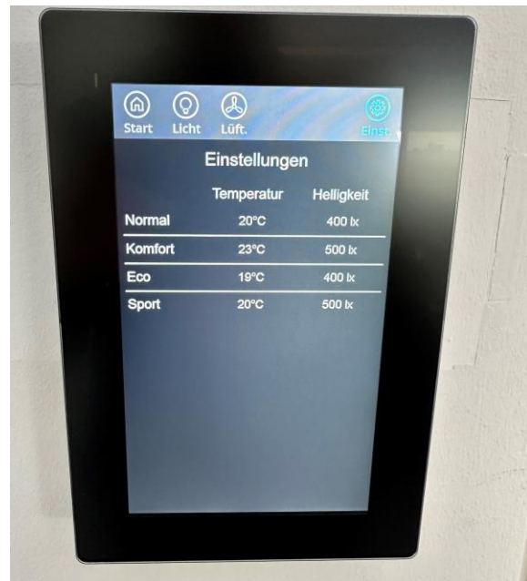
Abbildung 3: Bediendisplay mit Modi und einstellbarer Parameter
